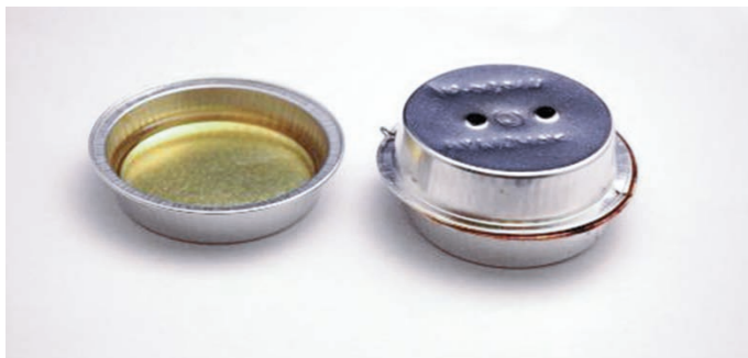
En ensayo se lleva a cabo en un recipiente con tapa en el que se simulan las condiciones de servicio de la cadena.
